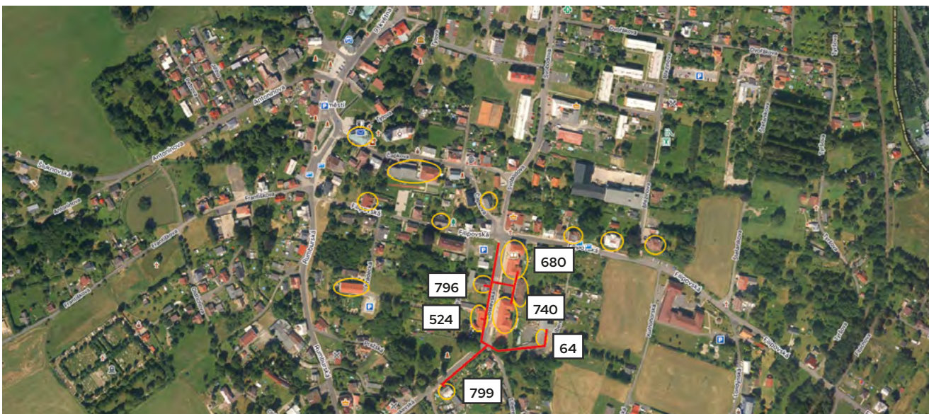
Obrázek 8: Návrh vedení teplovodu sítě CZT-A
