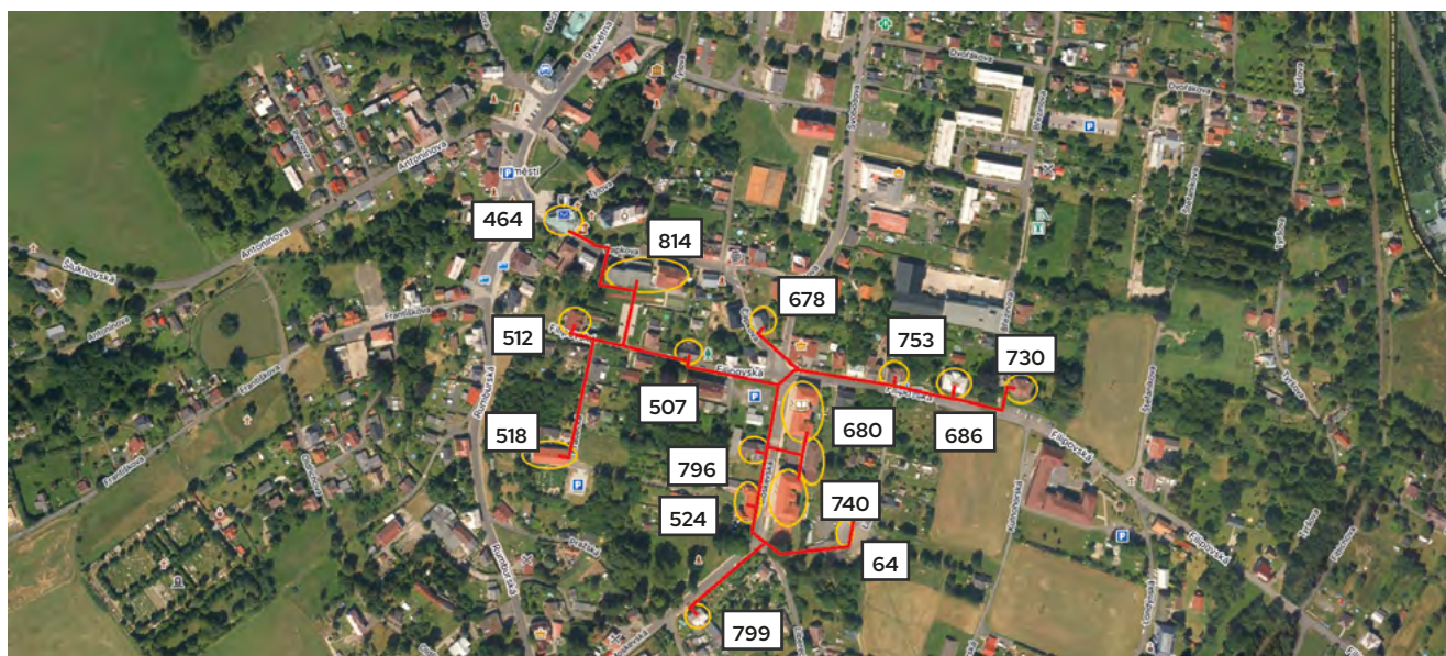
Obrázek 1: Návrh vedení teplovodu sítě CZT-MAX
