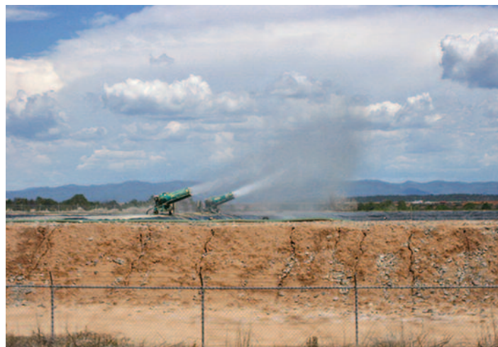
U některých vrtů se pro zvýšení rychlosti vypařování frakovacích kapalin používají vodní děla. To vede k dalšímu znečištění ovzduší.
